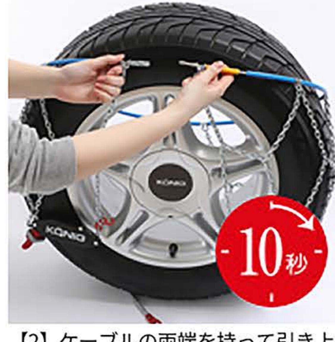
【2】ケーブルの両端を持って引き上げ、ケーブルジョイントをかけます。
