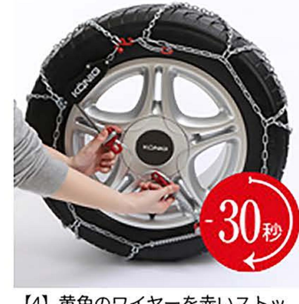
【4】黄色のワイヤーを赤いストップバーに通し、黄色のゴムを引っ張れば取付け終了。
